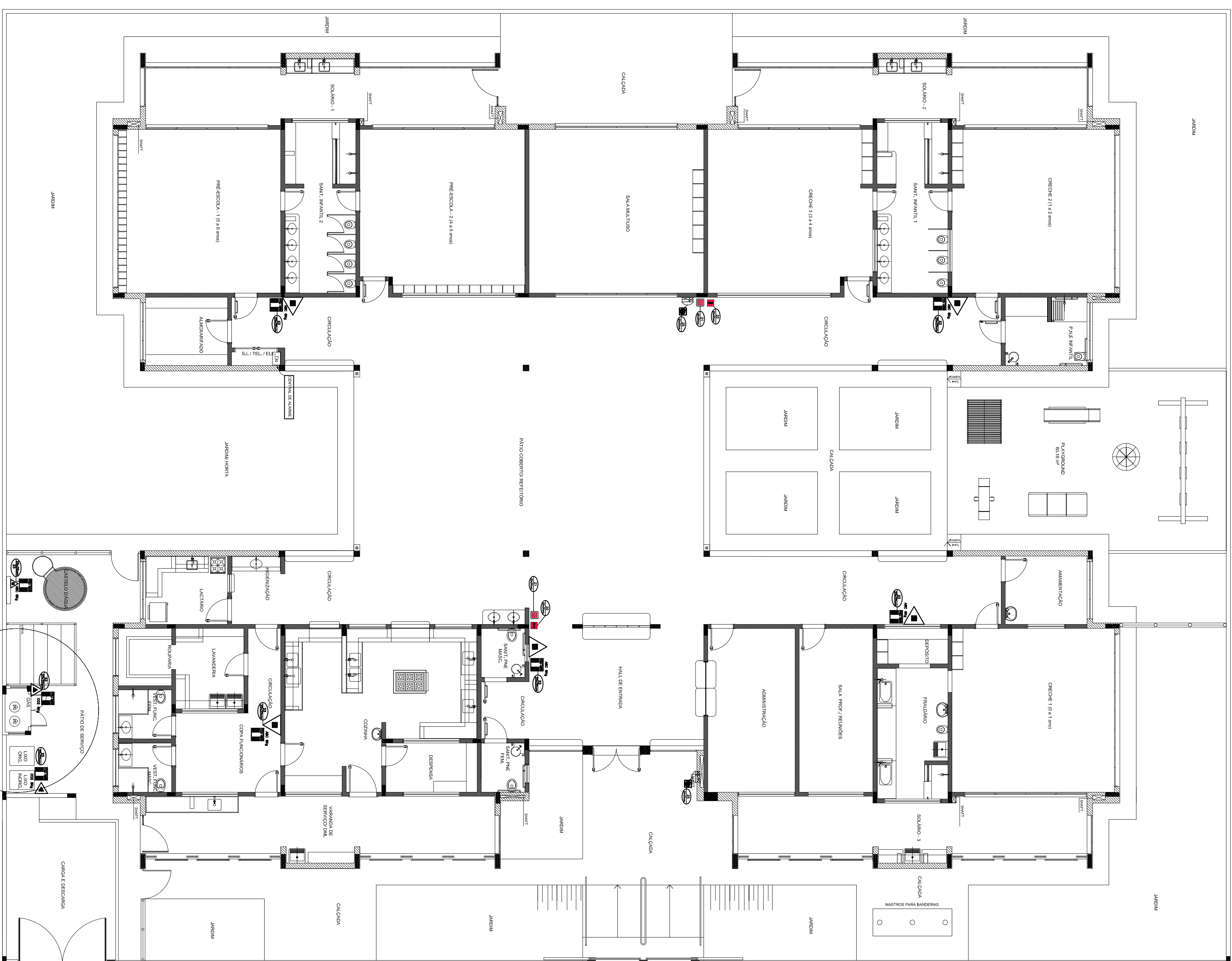
5 PLANTA BAIXA - LOCAÇÃO DOS EXTINTORES ESCALA 1/100
